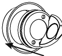
3. Прижмите прибор в силиконовом держателе к ладони и поверните ключ против часовой стрелки пока не услышите характерный щелчок
