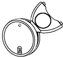
2. Поместите прибор в силиконовый держатель с вакуумной присоской и вставьте ключ в углубления на корпусе прибора как показано на рисунке
